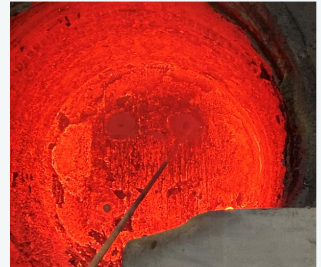
Anspritzen der Kegel mit Al 2 O 3 -Feuerfestspritzmasse
